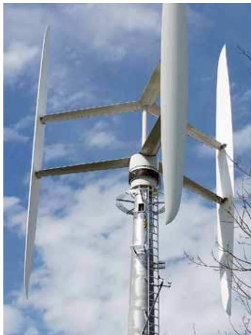
Leichtwindkraftwerk mit vertikalen Rotoren
